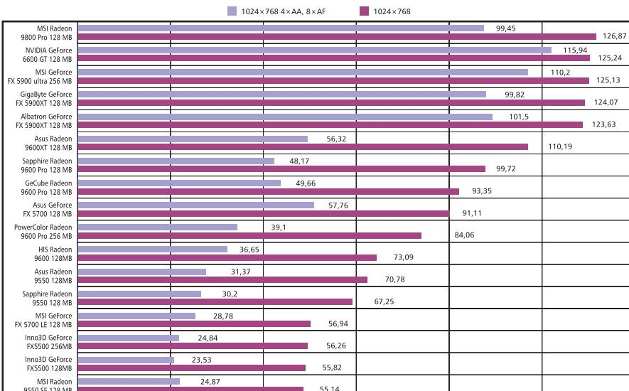
Nový Unreal nedal kartám až tak zbrať a v rozlíšení 1024x768 pri vysokých detailoch podali všetky karty prakticky hrateľný výkon. V prípade zapnutého AA a AF sa okrem GeForce 6600 GT výkon prepadá, ale aj tak hrateľný výkon začína v strede testovacieho pola.
