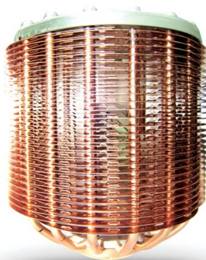
Celomedený chladič procesora s označením CNPS8000A od výrobcu Zalman – cez chladič prechádza 14 heat-pipe trubic a vnútri chladiča sa nachádza tichý ventilátor
