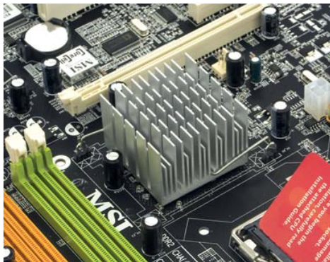
Zľava: Aktívne chladenie čipovej súpravy nVidia nForce 3 (doska Epox 9NDA3+), pasívne chladenie severného mosta čipovej súpravy i915 (doska MSI MS915G Neo2 Platinum)
