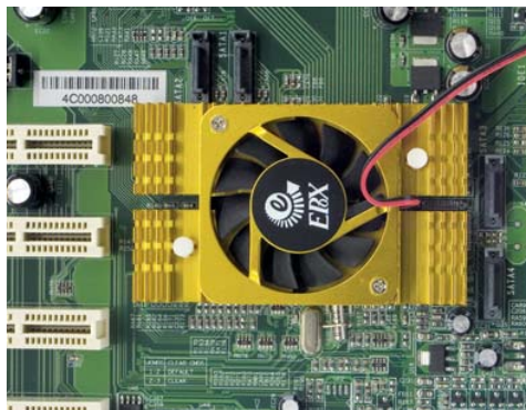
Zľava: Aktívne chladenie čipovej súpravy nVidia nForce 3 (doska Epox 9NDA3+), pasívne chladenie severného mosta čipovej súpravy i915 (doska MSI MS915G Neo2 Platinum)
